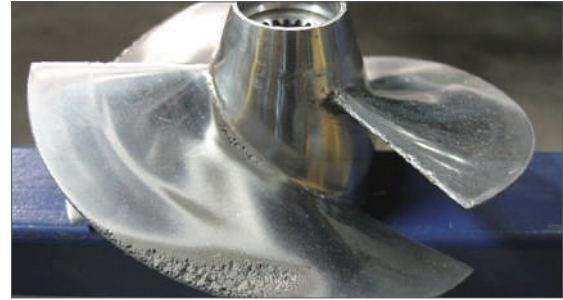
그림 2. 캐비테이션 현상으로 인한 프로펠러 손상
